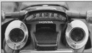
LED-Rückleuchte und Egu-Doppelrohr-Schalldämpfer
