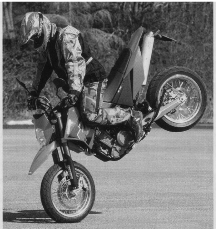
Dank 320er Scheibe und Brembo-Vierkolben-Bremszange genügen zwei Finger, um die KTM zum Stoppie zu bitten
