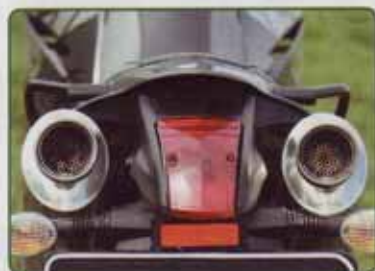
Etwas schlankere Heckansicht mit den Egu-Schalldämpfern, Sieb für den Sporteinsatz herausnehmbar
