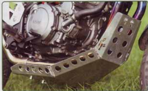
Sehr robuster Leichtmetall-Schutz für die Krümmer und den mittragenden Motor
