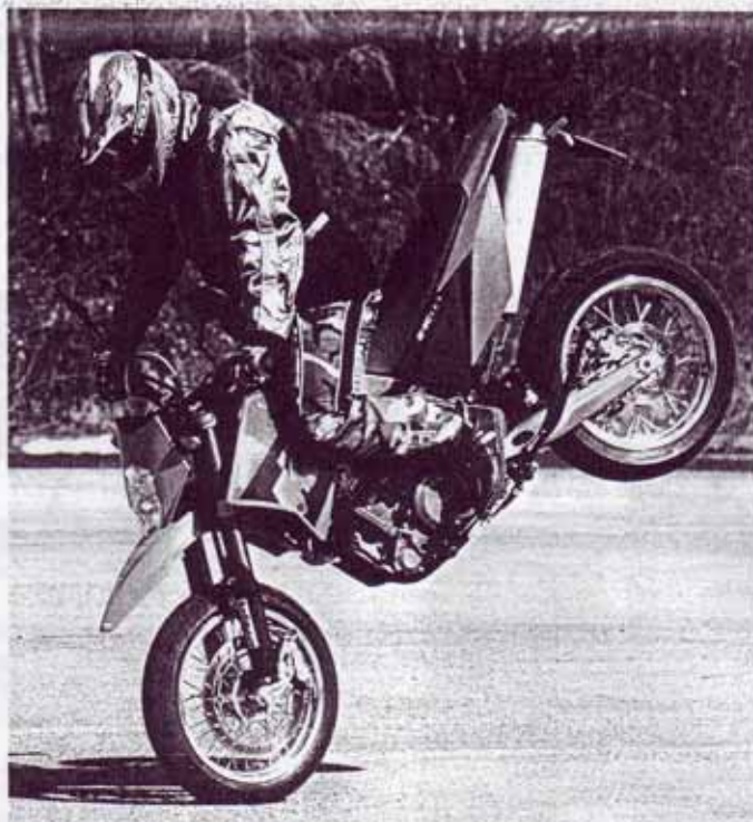
Dank 320er Scheibe und Brembo-Vierkolben-Bremszange genügen zwei Finger, um die KTM zum Stoppie zu bitten
