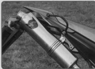
Robust und langlebig – der Edelstahl-Schalldämpfer ist weniger empfindlich als das Original
