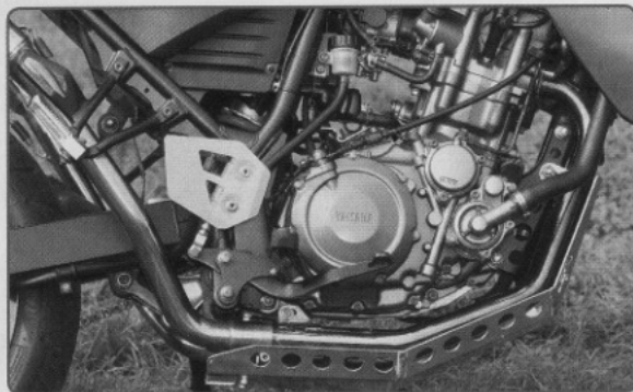
Moderner Einzylinder mit elektronischer Einspritzung und Egu-Leistungskrümmern
